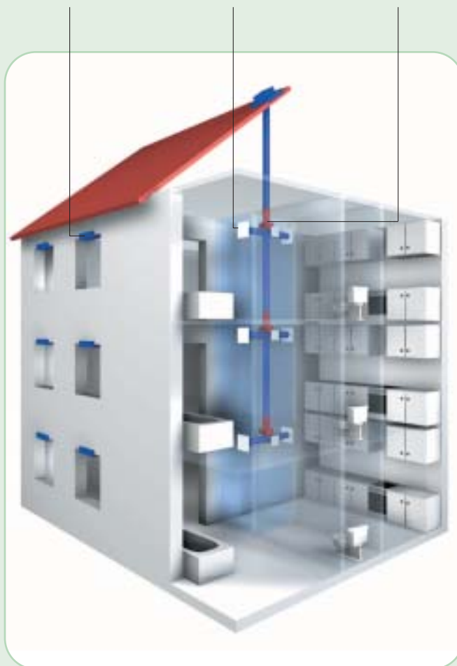
Akár 40 készülékig 20 emelet magasságig egyetlen közös felszállóval. A tűzvédelmi elemek megakadályozzák a tűz és füst átvitelét a többi szintre.
